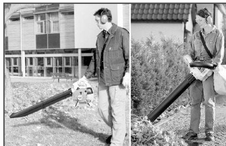
Рис. 9 Положение оператора при работе воздуходувным устройством
